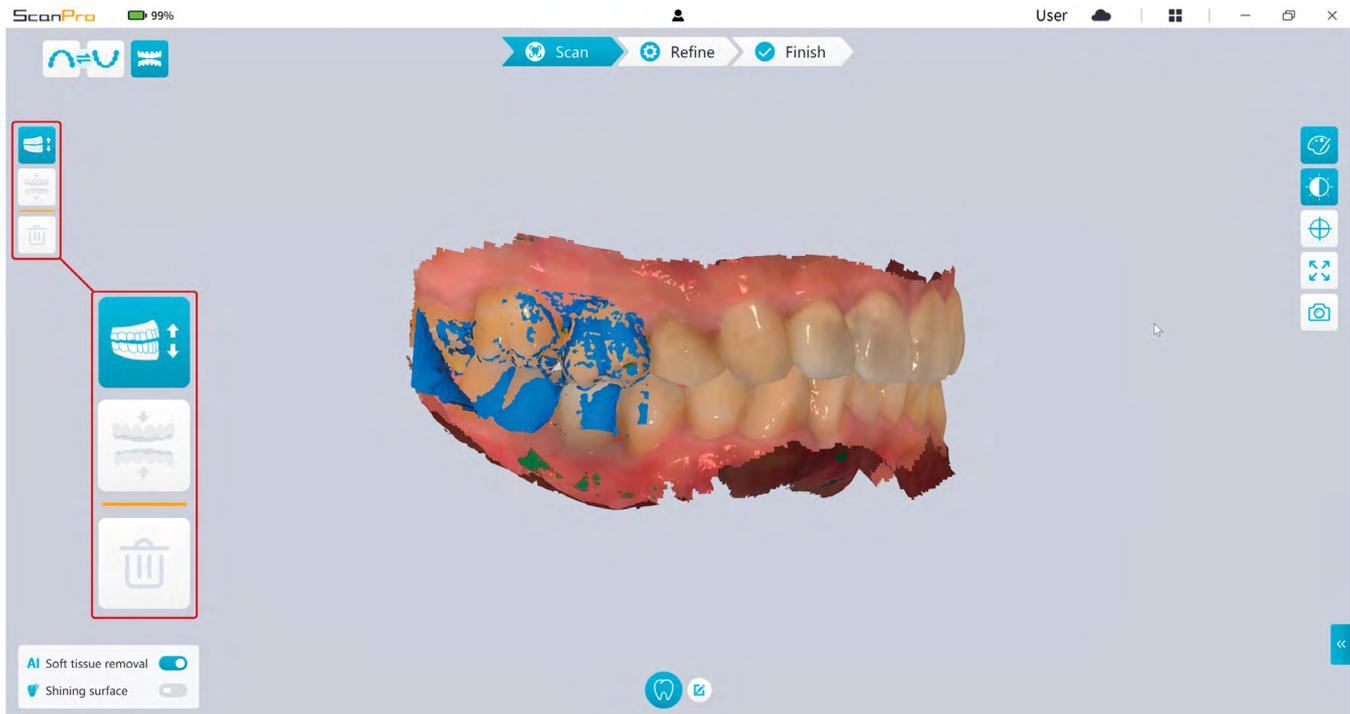
**NOTA:** È possibile eseguire la scansione di una o due registrazioni dell' impronta buccale. Si raccomanda di eseguire una scansione sul lato sinistro e un' altra scansione sul lato destro della bocca del paziente.
